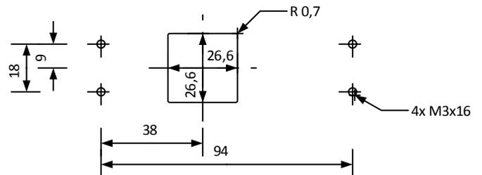
Montage mit zusätzlichen Bolzen. Halterung kann zusätzlich verschraubt werden
